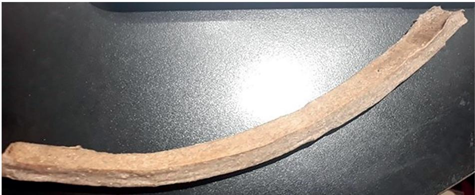
**Figura 1.** Probeta de caucho con refuerzo de cascarilla de semilla de caucho.
