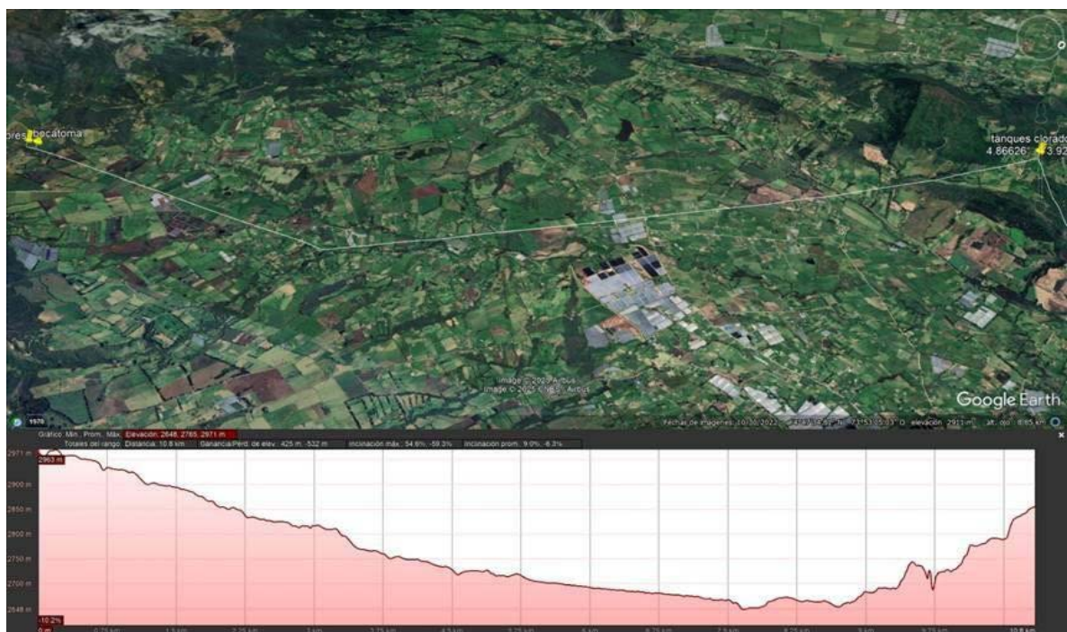
Figura 7. Perfil de elevación ruta 2, tanque sedimentador - tanque clorador.
